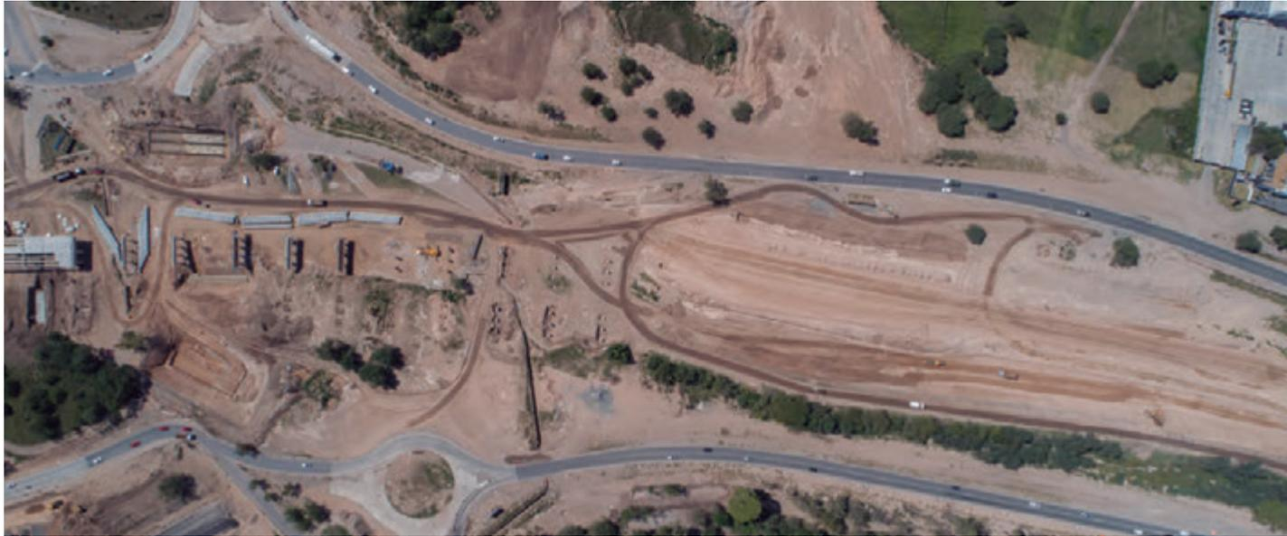
Vista aérea de las tareas de movimiento de suelos requerido para el trazado de las nuevas rotondas de conexión. A la izquierda se ve el avance del viaducto, los pórticos ya elevados y las losas sobre las que se desarrollará la vía sobre el suelo a la espera de su colocación.
